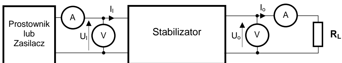
Rys. 6.2.1. Układ pomiarowy stabilizatorów.
